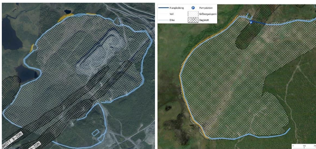
Figur 12. Exempel på placering av diken (blå) och vallar (gul) runt norra gråbergsdeponin (t.v.) och södra gråbergsdeponin (t.h).
