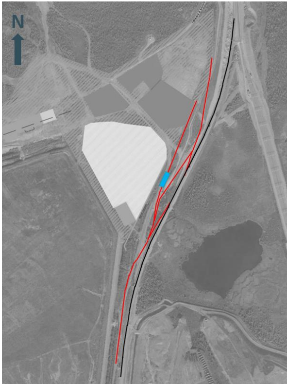
Figur 23. Planerad järnvägsanslutning och bangård (rött) tillsammans med omlastningsstation (blått) och befintlig järnväg (svart).
