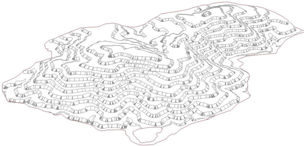
Figur 25. Exempel på deponeringsplan med terrassering (organisk form) för den norra gråbergsdeponin (VAST, 2021).
