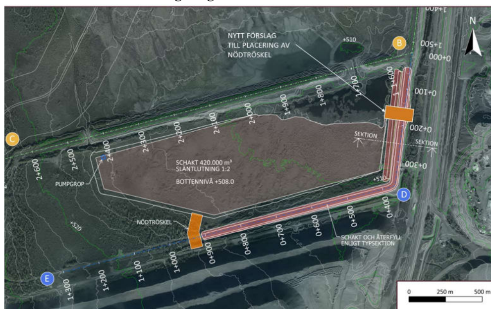
Figur 5: Schematisk plan (från tidigare Bilaga D7 (Bilaga A.3-D, aktbil. 95)) som visar tidigare och nu föreslagen placering (orange rektanglar) av nödutskovströskel i klarningsmagasinet
