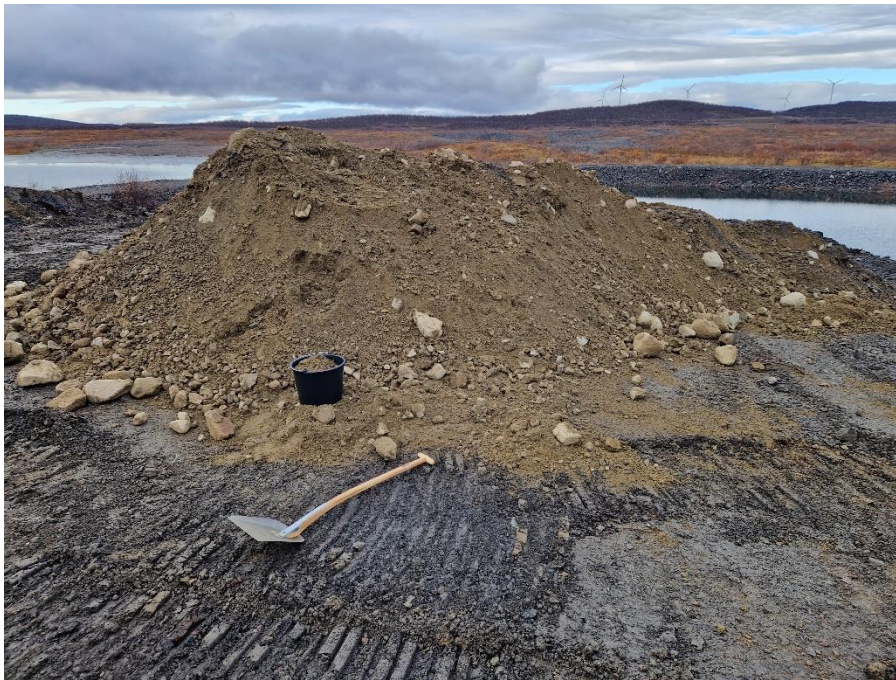
Figur 3 Sorterad morän från tät kärna.
